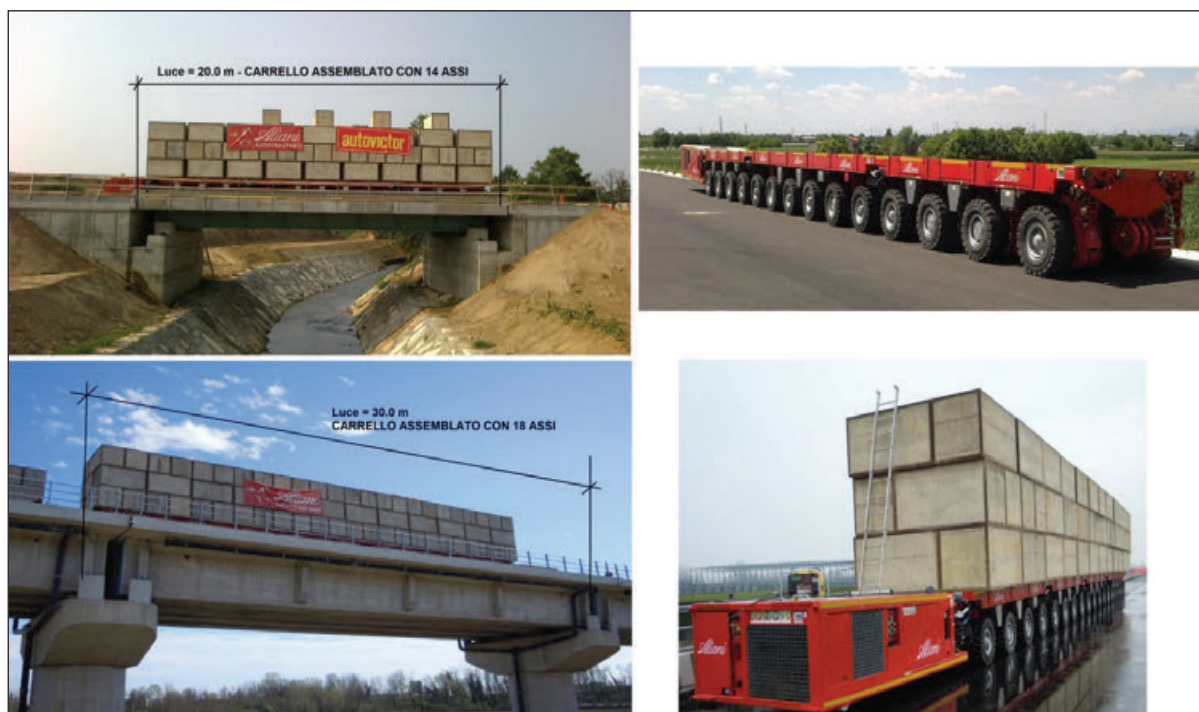
Figura 12 - Esempi di assemblaggio moduli a 14 o 18 assi
