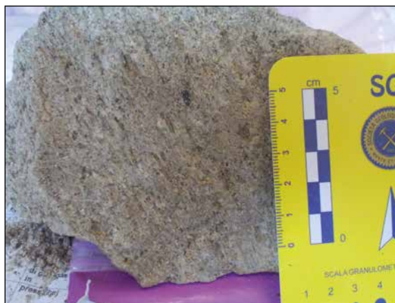
Fig. 10 - Campione delle arenarie della Formazione di Castelvetere (CVT) utilizzato per le analisi petrografiche.
