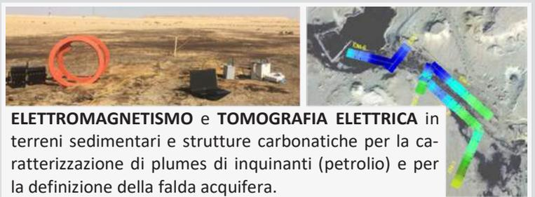
**ELETTROMAGNETISMO** e **TOMOGRAFIA ELETTRICA** in terreni sedimentari e strutture carbonatiche per la caratterizzazione di plumes di inquinanti (petrolio) e per la definizione della falda acquifera.
