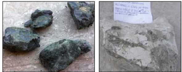
**Fig. 25** - Galleria Pavoncelli bis: campioni di argilliti grigio-verdastro e calcari marnosi avana riferiti alla Formazione delle Argille Varicolori (ALV) prelevati dallo smarino intorno a pk 7590 m circa.
