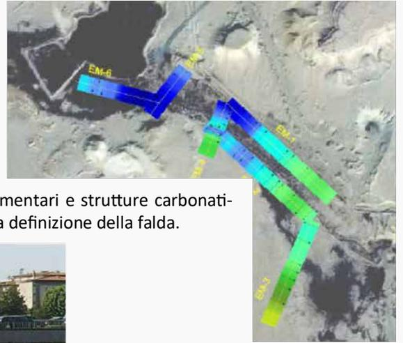
**ELETTROMAGNETISMO e TOMOGRAFIA ELETTRICA** in terreni sedimentari e strutture carbonatiche per la caratterizzazione di plumes di inquinanti (petrolio) e per la definizione della falda.
