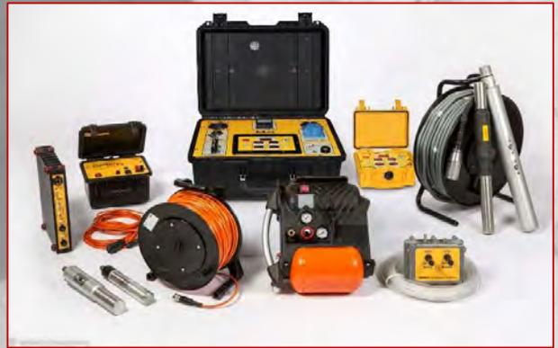
STRUMENTAZIONE PER CROSS-HOLE
