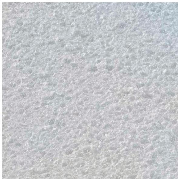
Figura 2. Superficie di lastra isolante in aerogel di diossido di silicio (lastra in aerogel prodotta da STO Italia s.r.l.).
