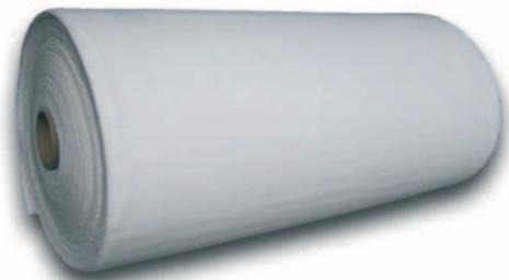
Figura 6. Feltro isolante ultrasottile in aerogel, normalmente disponibile in rotolo negli spessori 5-10 mm. Risulta particolarmente indicato nell'isolamento, nell'ambito degli interventi di recupero e ristrutturazione edilizia, dei solai e delle coperture piane e a falde, nonché per la risoluzione di ponti termici di diverso tipo. (L'immagine si riferisce allo specifico prodotto Aerogel-Spaceloft, prodotto dall'azienda Ecofine nanotechnologies; [www.ecofine.it](http://www.ecofine.it)).
