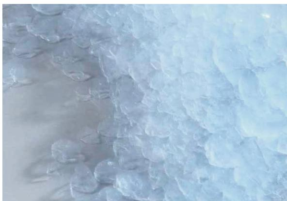
Figura 4. Particolare della struttura di un aerogel di diossido di silicio (immagine concessa dalla STO Italia srl).
