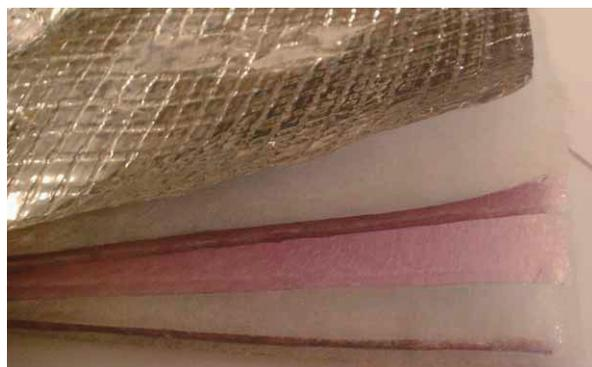
Figura 7. Isolante sottile multiriflettente. Sono visibili i differenti strati funzionali che costituiscono il pacchetto isolante, dai feltri ai fogli di alluminio riflettente.
