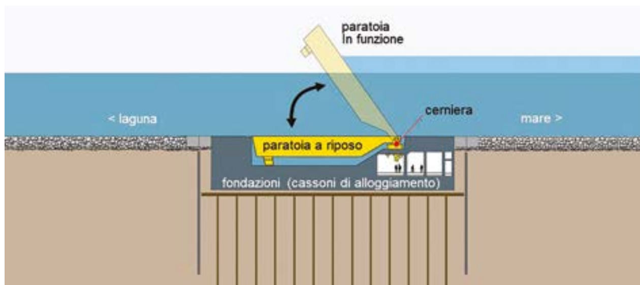
Fig. 5 | Sezione paratoie
