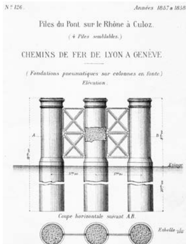
Fig. 13 | Ponte a Culoz: dettaglio costruttivo della pila costituita da tre tubi collegati mediante traversi e diagonali in ferro (Gouin 1878)
