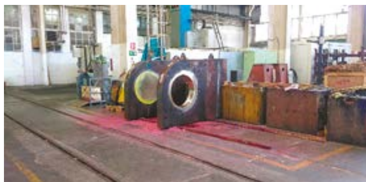
Fig. 5 | Fase di riporto metallico di Inconel 625 all'interno del foro delle pinne
