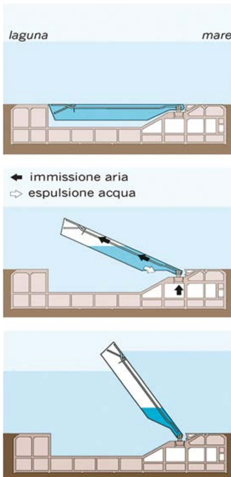
Fig. 1 | Schema di funzionamento delle paratoie
