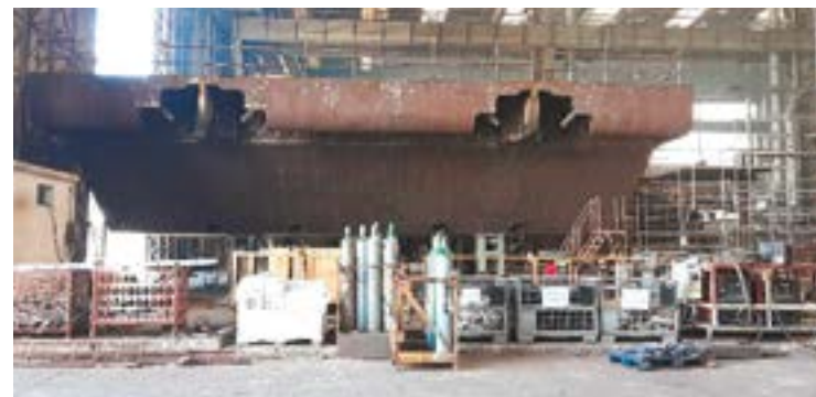
Fig. 7 | Assemblaggio finale della paratoia
