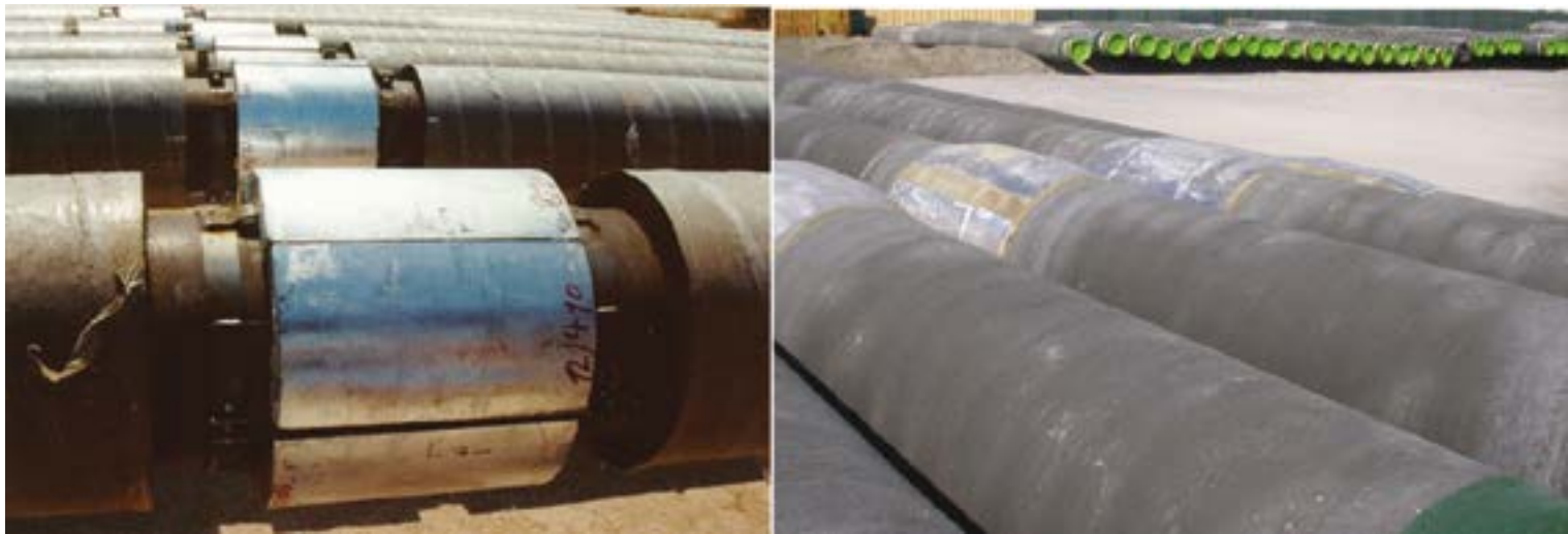
Fig. 3 | Esempio di montaggio di anodi a bracciale in lega di zinco su una tubazione in acciaio sottomarina (sinistra) aspetto delle tubazioni in acciaio con anodi e rivestimento (appesantimento) in calcestruzzo (destra)
