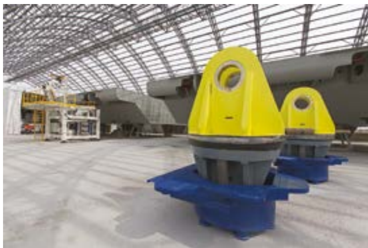
Fig. 2 | Predisposizione elementi "maschio" per montaggio su paratoia
