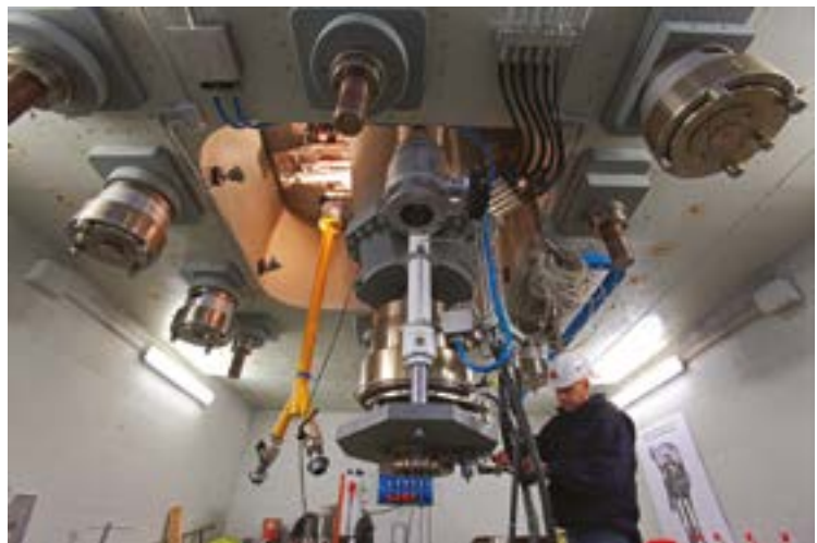
Fig. 8 | Campo Prove - assemblaggio del tensionatore
