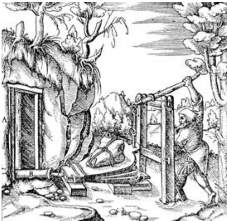
Fig. 1 | Ventilazione forzata di una miniera nel XVI secolo: mantici e tubazioni per l'immissione dell'aria negli spazi ipogei (Agricola, 1556).
