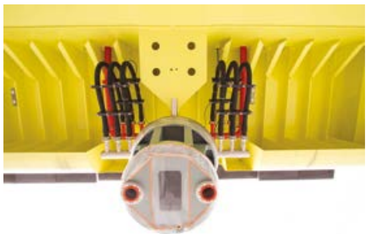
Fig. 9 | Dettaglio delle manichette di alimentazione della paratoia
