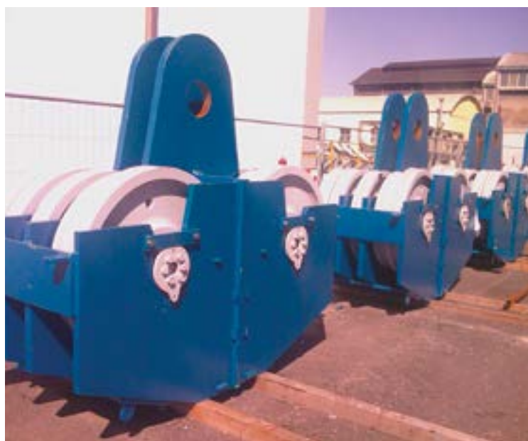
Fig. 4 | Le pulegge del Syncrolift prima di essere montate
