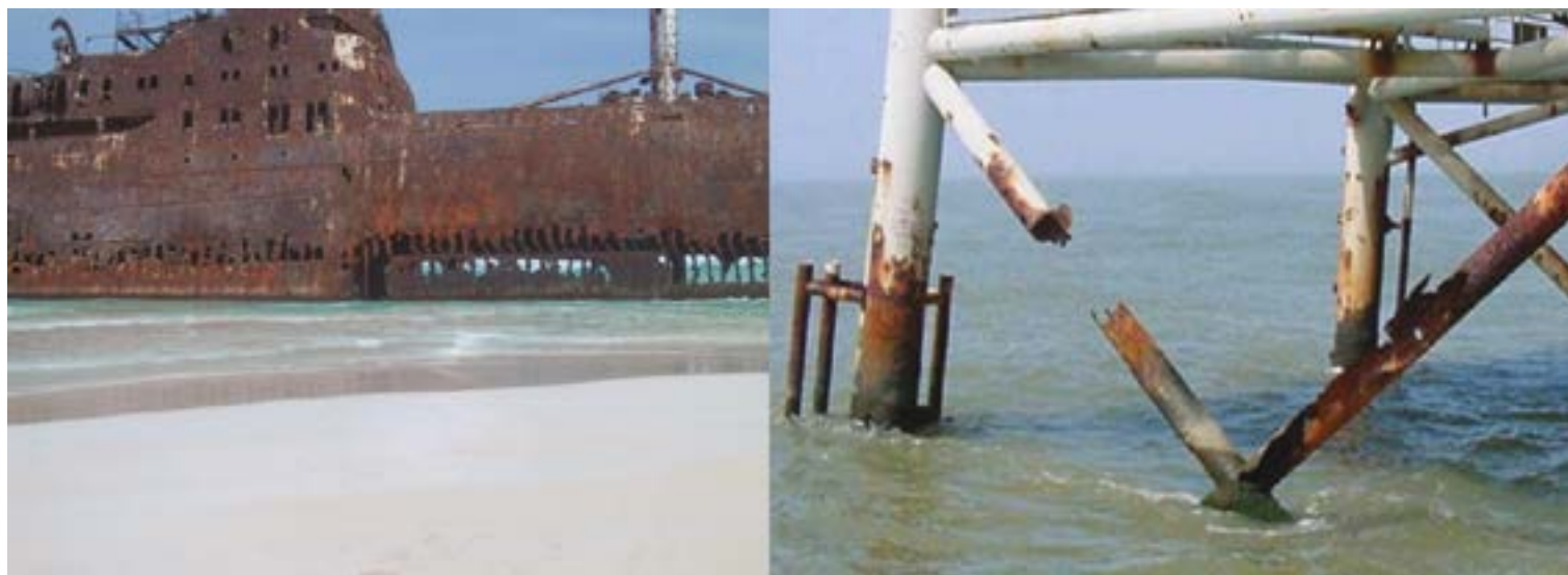
Fig. 1 | Esempio di corrosione di un relitto di nave (sinistra) corrosione di una piattaforma nella zona degli spruzzi e delle maree (destra)
