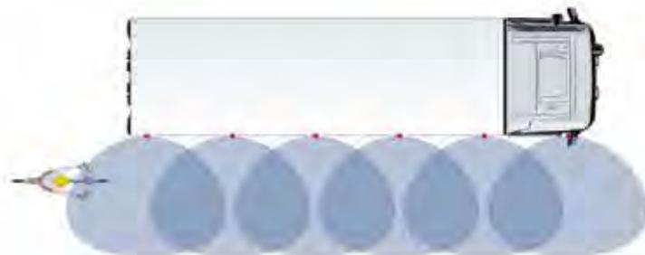
Sidescan® Predict è progettato per prevenire le collisioni tra i veicoli, gli ostacoli e gli utenti vulnerabili della strada: grazie ad un algoritmo che analizza dati come velocità, direzione e accelerazione, valuta il rischio e calcola la probabilità di un impatto.
