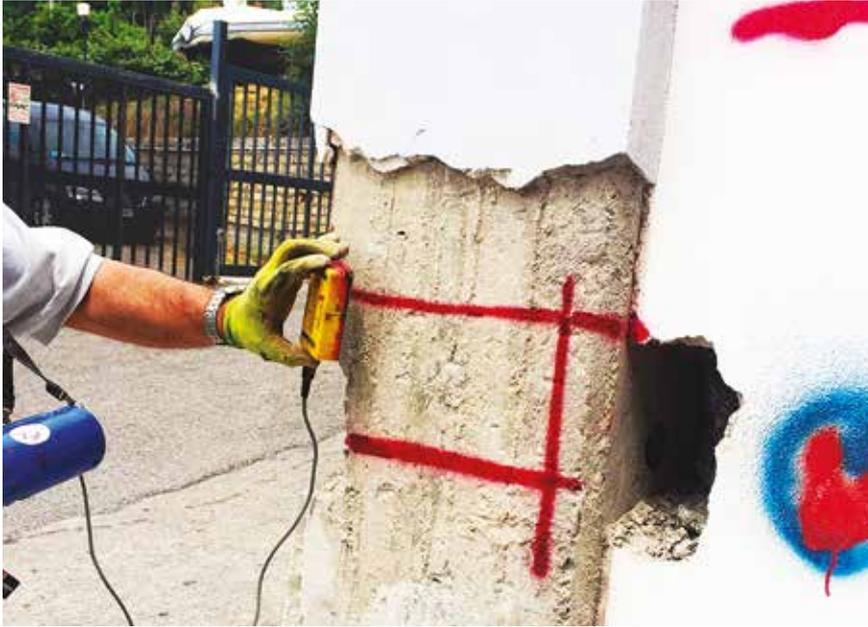
■ Per la misurazione dello spessore del copriferro delle armature possono essere utilizzati dispositivi magnetici chiamati pacometri
