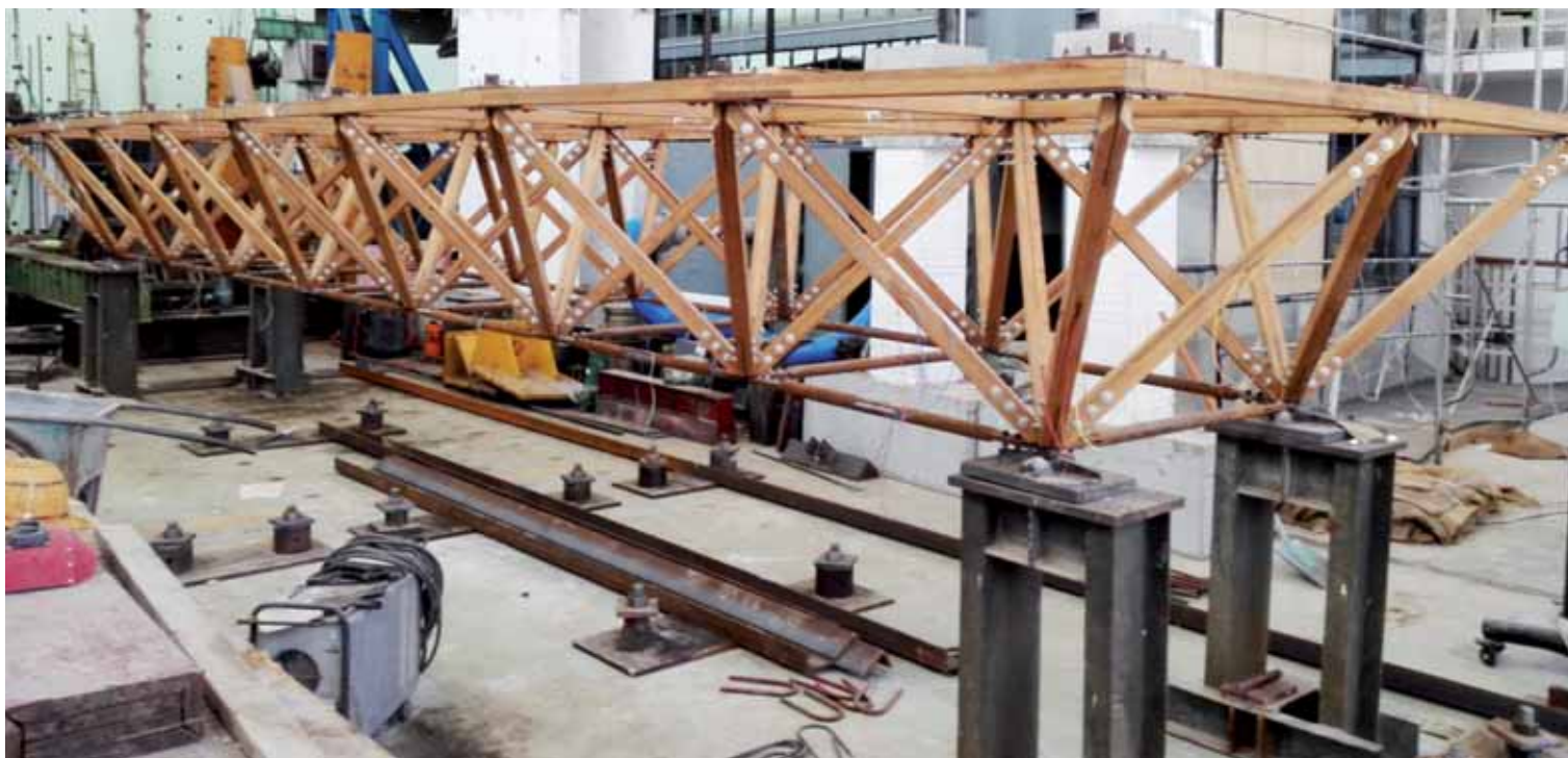
Fig. 1 - Prototipo della struttura reticolare ibrida in acciaio e glubam.
