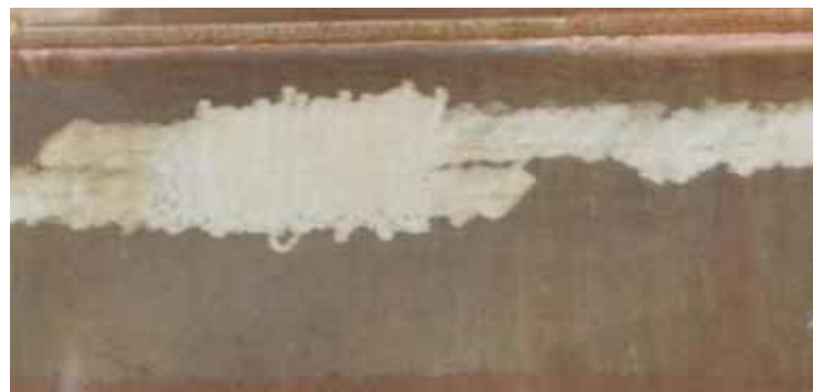
Fig. 6 - Asportazione di difetti lineari mediante molatura
