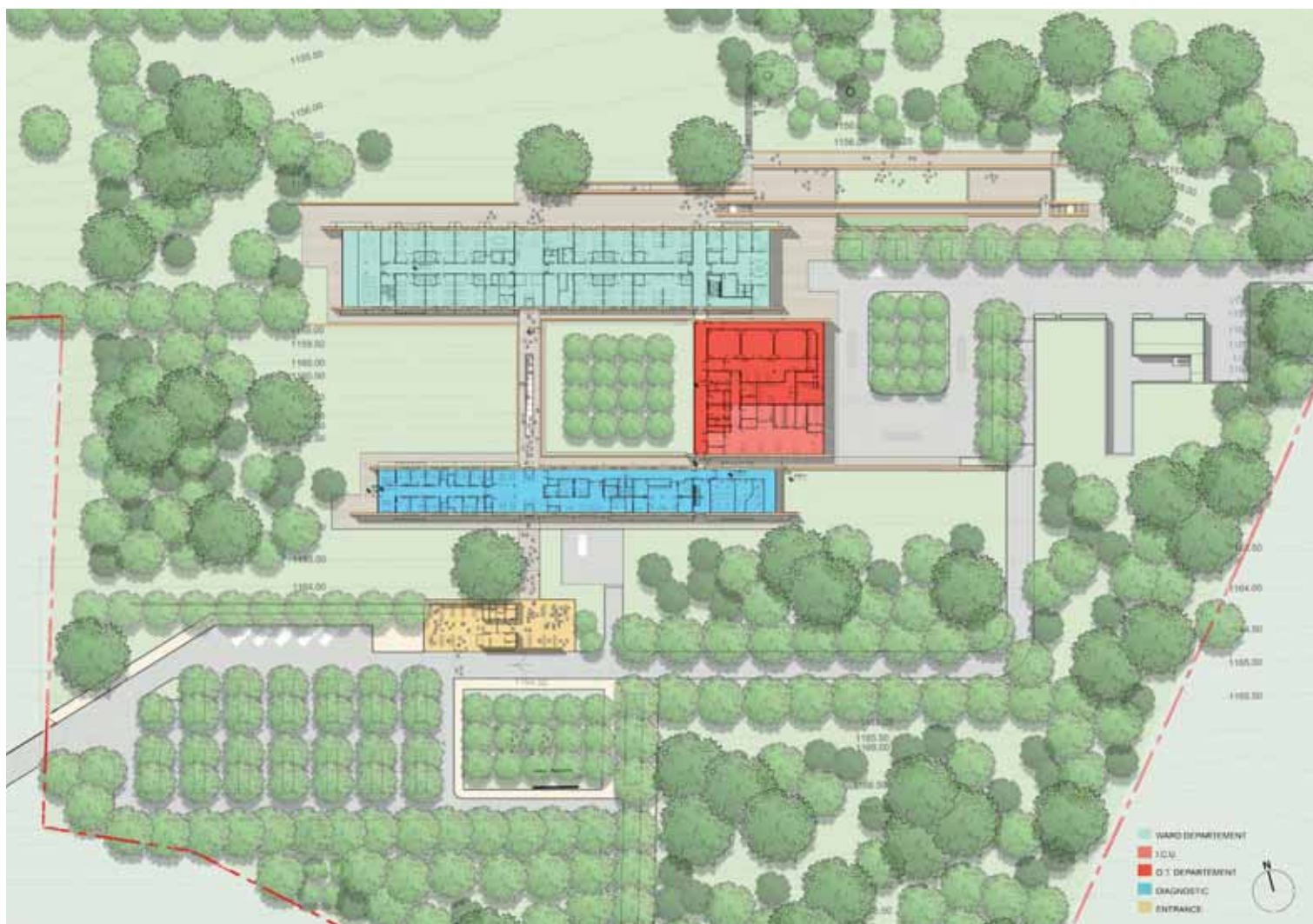
Fig. 9 - Planimetria funzionale del centro con indicazione delle diverse aree funzionali. © RPBW
