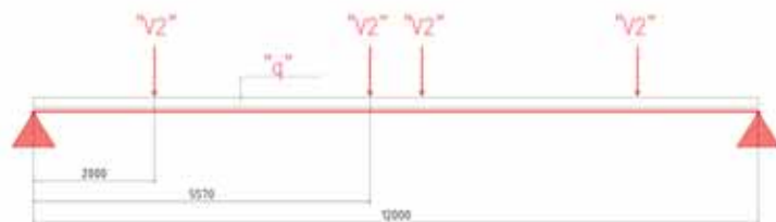
Fig. 4 - Schema trave marca 533-29 appoggio vagli
