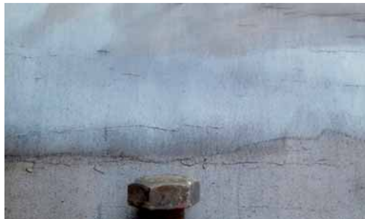
Fig. 3 - Individuazione delle cricche superficiali
