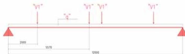
Fig. 5 - Schema trave marca 533-27 appoggio vagli
