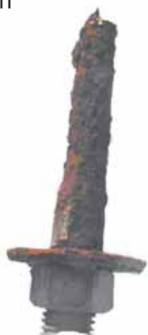
Fig. 11 – Tiranti del telo, ossidati per metà bullone, e indenni da attacchi ossidanti nel restante stelo. Fig. 12 – Dettagli dell'anello di funi centrale con bulloni ossidati. Fig.13 – corda in acciaio, o cavetto, e stelo. La corrosione ha fatto rompere alcuni fili dell'avvolgimento del cavetto. La sezione così ridotta ha ceduto.
