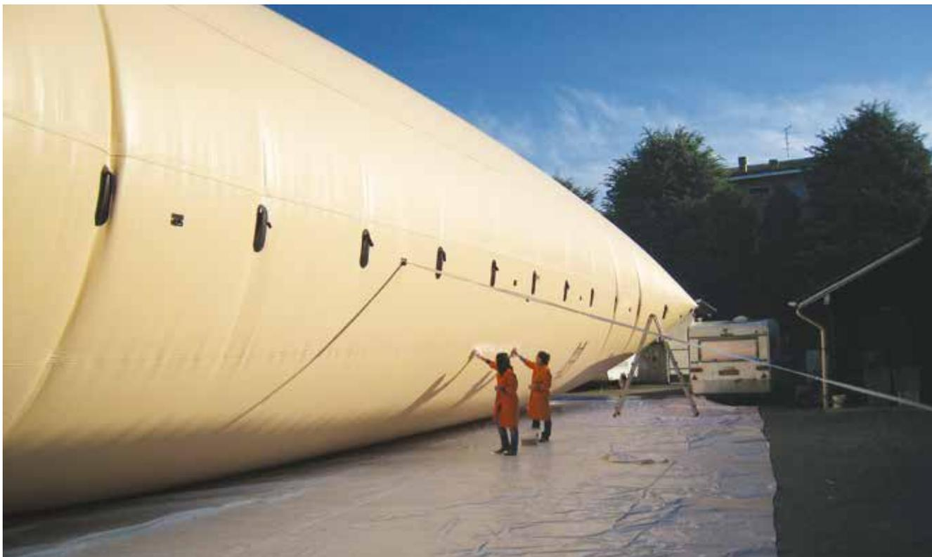
■ Test di controllo con gonfiaggio su cisterna da 400 mc per idrocarburi avionici
