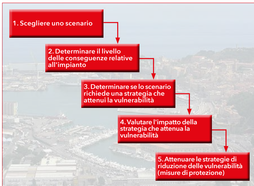
■ Diagramma di flusso di una valutazione della sicurezza basata su un'analisi del rischio semplificata (Linee guida C.I.S.M.)
