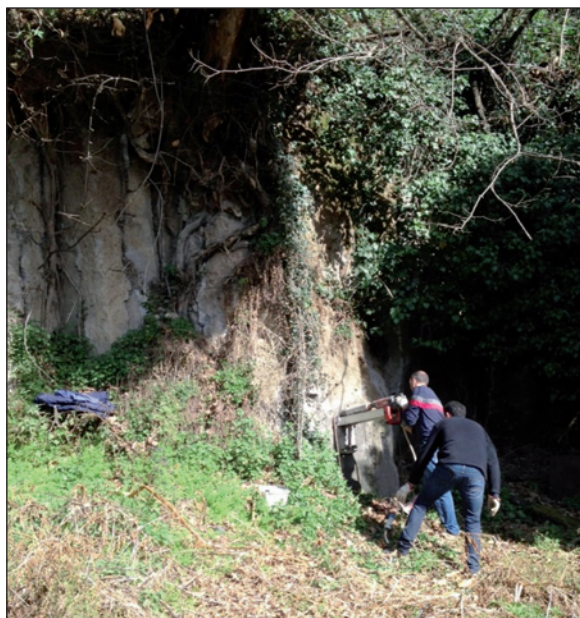
Fig. A-1 – Prelievo dei campioni mediante carotatrice
