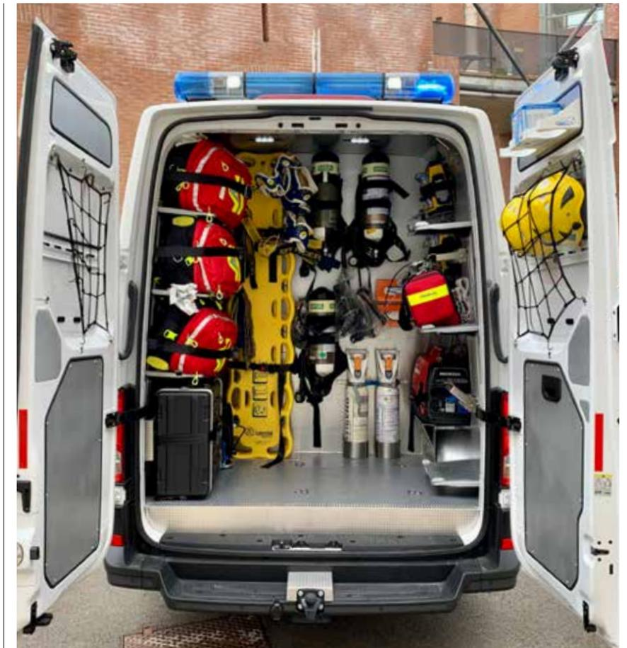
**Il MIR (Modulo di Intervento Rapido) a partenza immediata è un modulo furgonato, altamente tecnologico, dotato di un vano laterale con tre postazioni di Centrale Operativa EMS, e un vano posteriore configurato per alloggiare tutto l'occorrente necessario al pronto impiego di tre unità medicalizzate in grado di accorciare, ulteriormente, i tempi di intervento**
