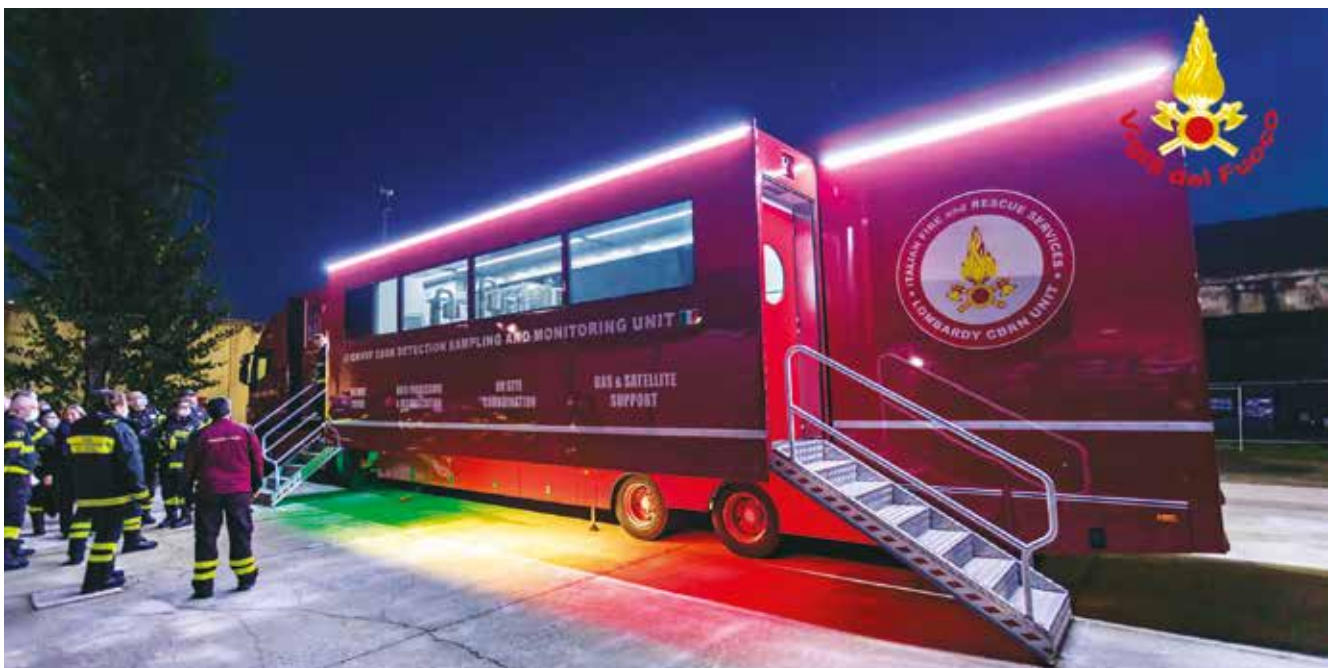
■ Il nuovo modulo prototipale RescUE CBRN (denominato Motorhome) allestito recentemente e contenente un laboratorio mobile per analisi biologiche, ivi comprese le apparecchiature per la processazione dei tamponi molecolari
