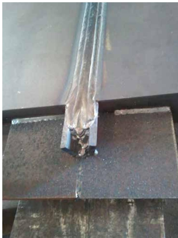
Fig. 11 | Preparazione per giunto testa a testa in officina.
