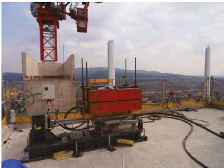
Fig. 10 | L'attuatore dinamico utilizzato per generare la forzante orizzontale, collocato in sommità alla torre e disposto in direzione longitudinale.
