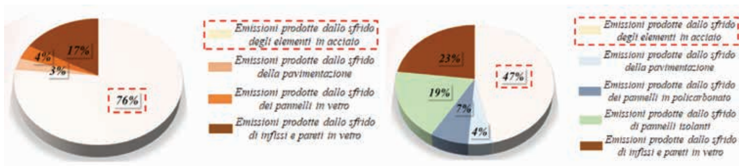
Fig. 37 | Emissioni di CO 2eq,2 prodotte dallo sfrido conseguente alle operazioni di demolizione e incidenza emissioni prodotte dallo sfrido (Avenida Central Building, a sinistra; Melopee school, a destra)
