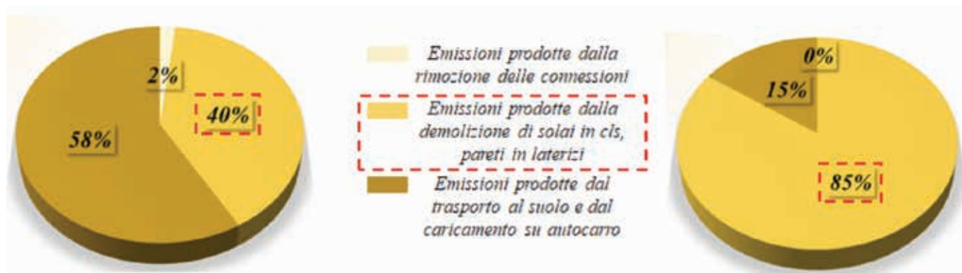
Fig. 36 | Risultati in termini di tonnellate CO 2eq e incidenza delle diverse attività di demolizione (Avenida Central Building, a sinistra; Melopec school, a destra)
