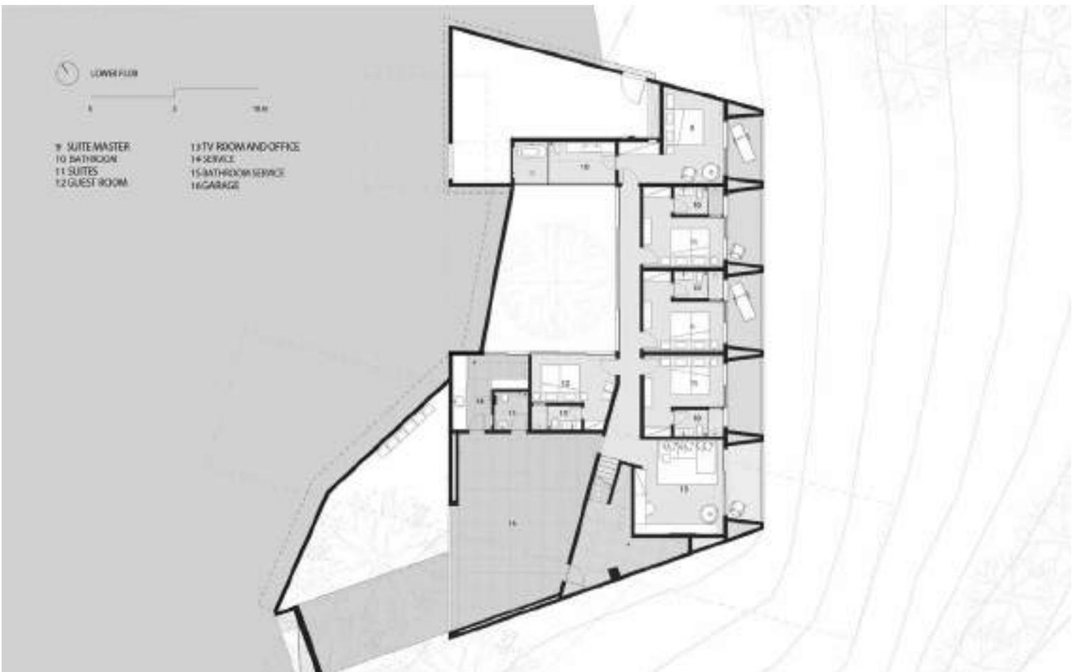
Fig. 10 | Pianta del piano inferiore, parzialmente interrato (basamento in calcestruzzo).
