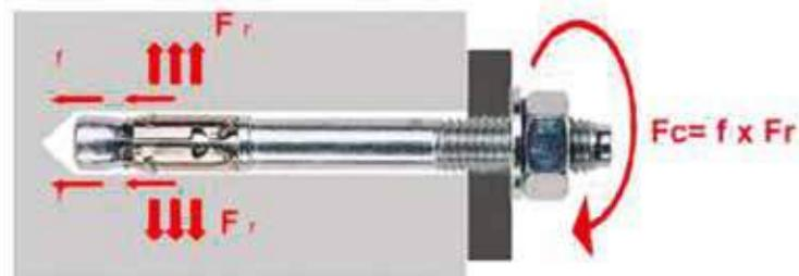
Fig. 6 | Coppia di serraggio ed effetto sul supporto
