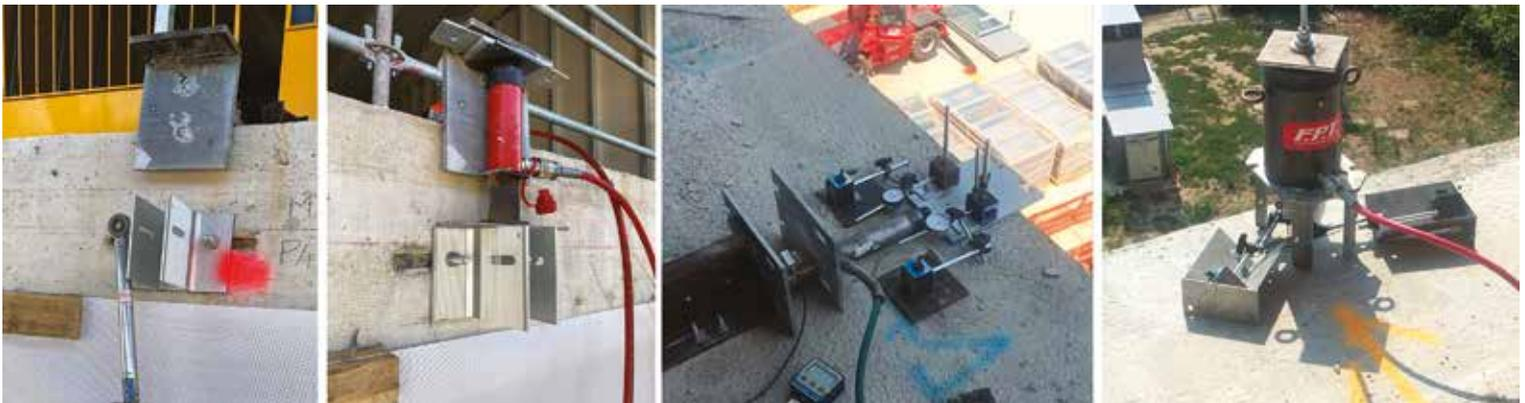
Fig.9 | Prova di carico su staffe e canali annegati
