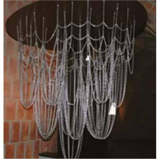
Fig. 10 | Modelli in scala di archi catenari
