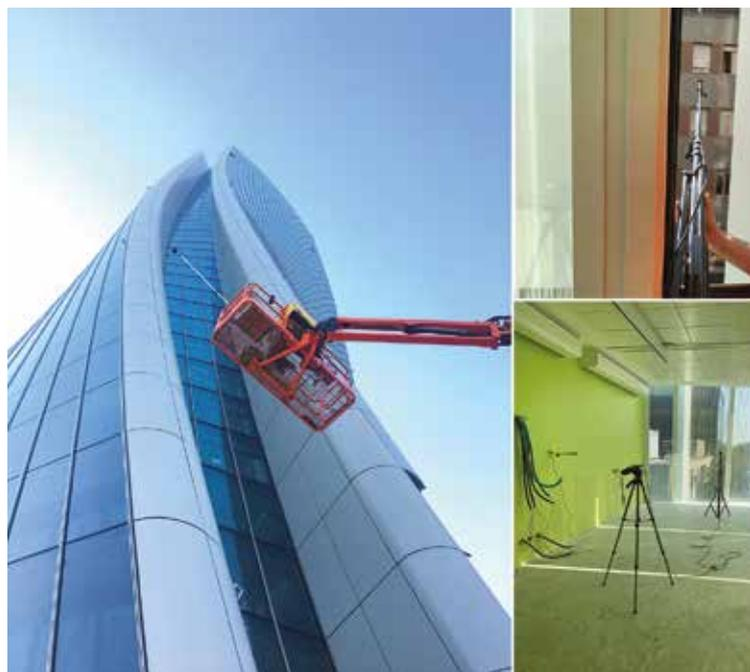
Fig. 12 | Misure in sito dell'isolamento acustico del rumore per via aerea di parti di facciata
