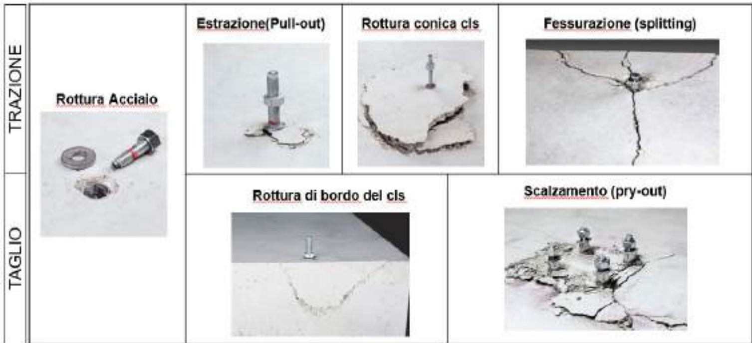
Fig. 3 | Immagini rappresentative delle tipologie di rottura
