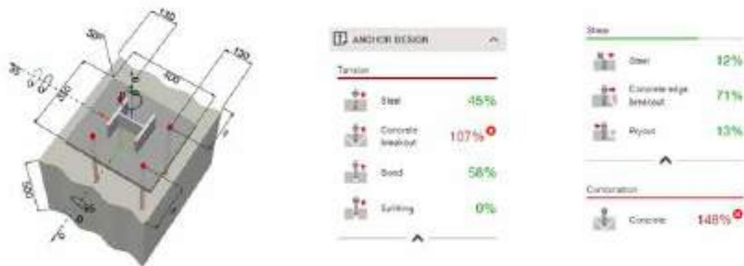
Fig. 12: Esempio di barriera; Verifiche senza le armature supplementari
