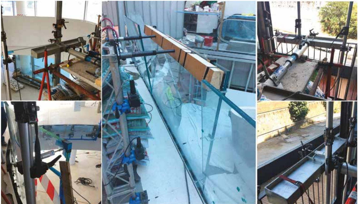
Fig. 18 | Prova di carico per la determinazione della resistenza al carico statico lineare
