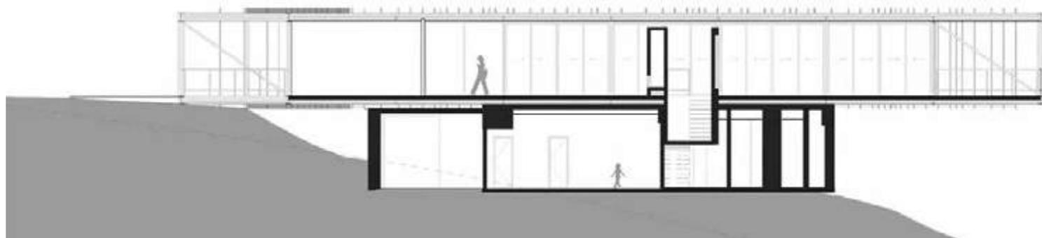
Fig. 14 | Sezione verticale longitudinale dell'edificio, lungo lo sviluppo del volume in struttura metallica.
