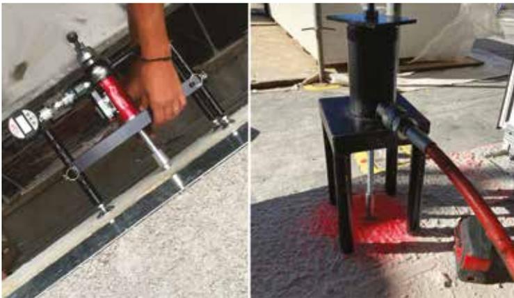
Fig. 8 | Prova di estrazione di un tassello
