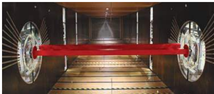
Fig. 74 | Modello sezionale torri in scala 1:70
