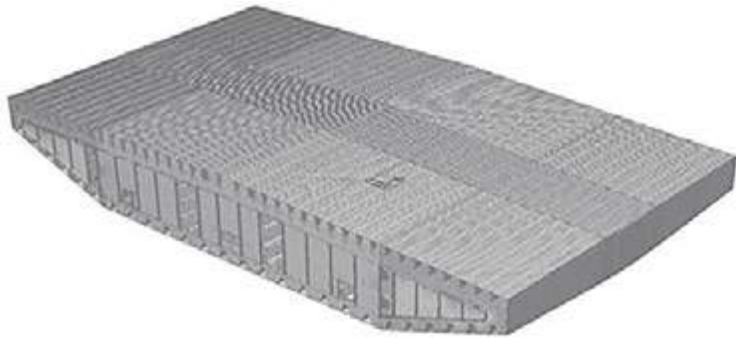
Fig. 56 | Modello EF per conio impalcato in corrispondenza delle torri
