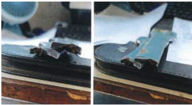
Fig. 8 | Prove di trazione eseguite sui campioni di acciaio in laboratorio.
