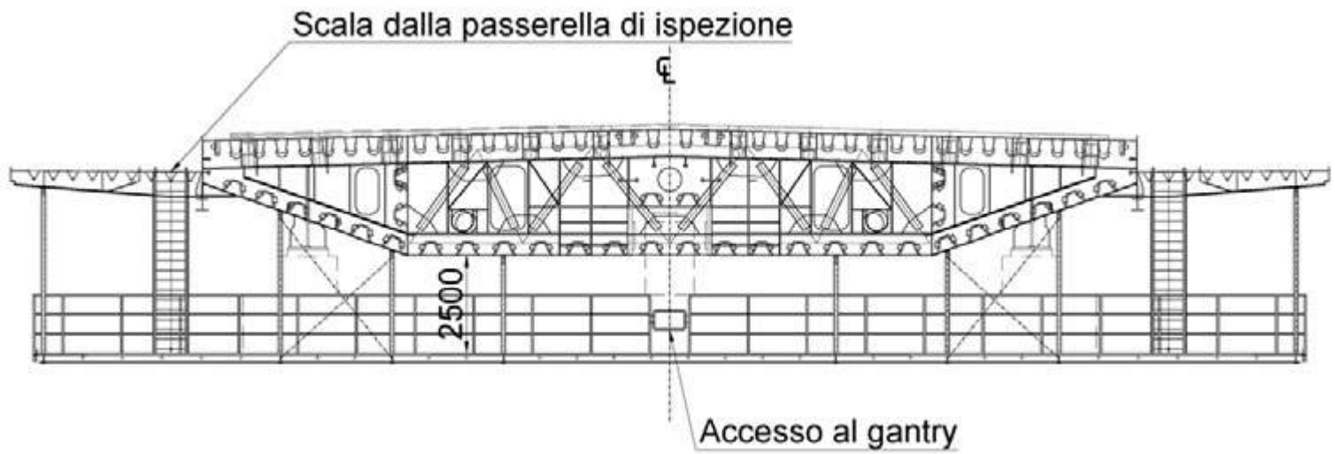
Fig. 92 | Passerella di ispezione in prossimità dei blocchi di ancoraggio
