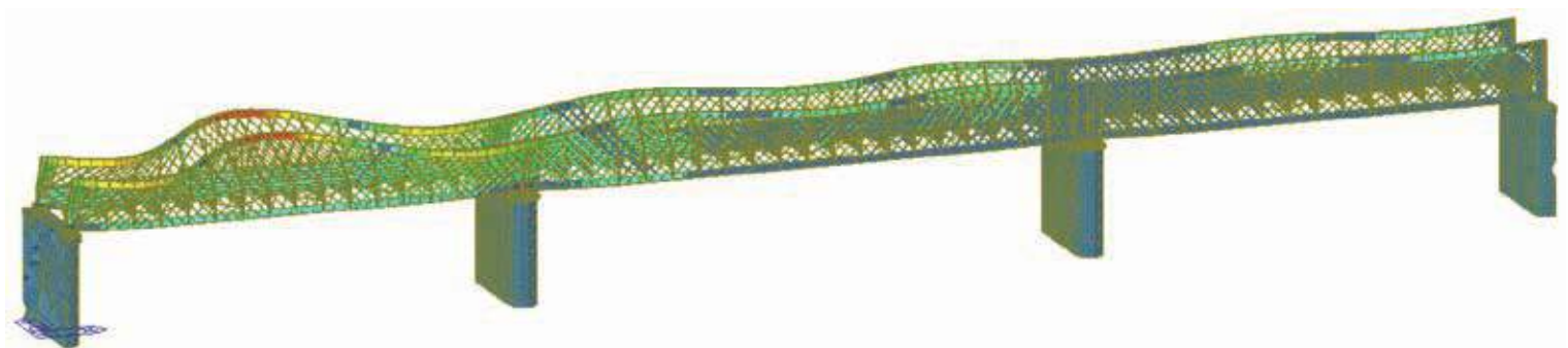
Fig. 7 | Deformata modo 1-Y
