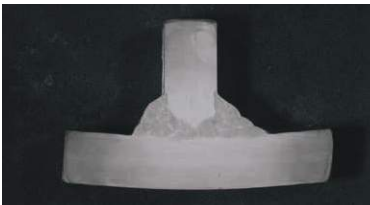
Fig. 4 | Giunto a T a completa penetrazione (CJP).
