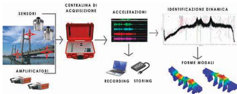
Fig. 4 | Catena di misura
