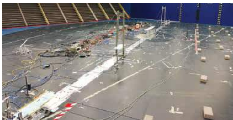
Fig. 77 | Modello 3D del ponte durante la costruzione con 1/5 dell'impalcato completato - scala 1:150
