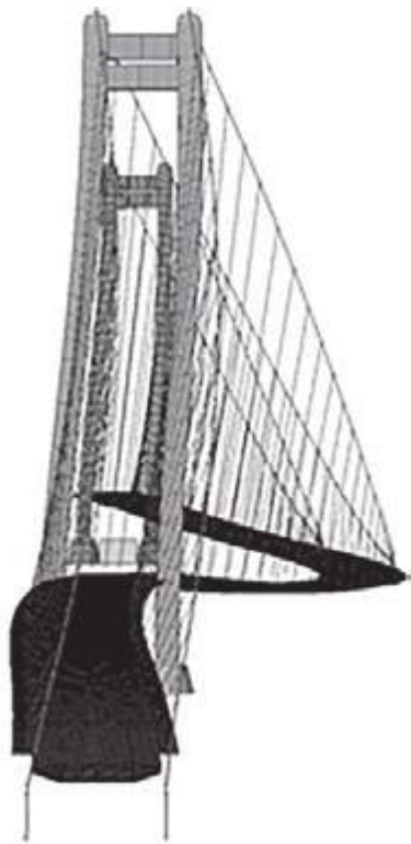
Fig. 47 | Deformata per vento trasversale, spostamento massimo ~ 2 m
