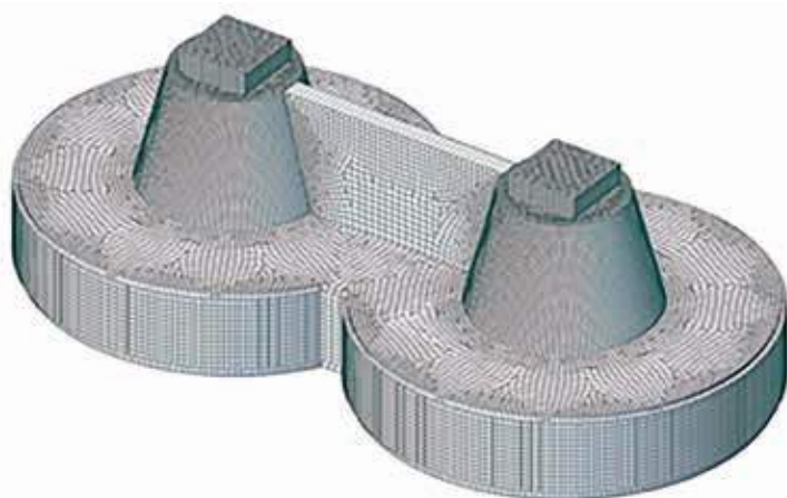
Fig. 63 | Modello EF locale del plinto di fondazione delle torri
