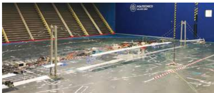
Fig. 76 | Modello 3D del ponte durante la costruzione con 2/3 dell'impalcato completato - scala 1:150
