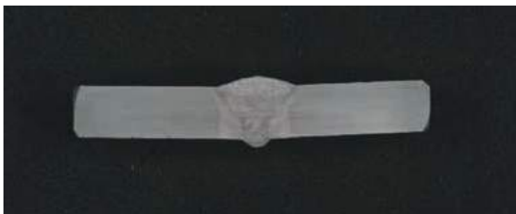
Fig. 3 | Giunto testa a testa a completa penetrazione (CJP).
