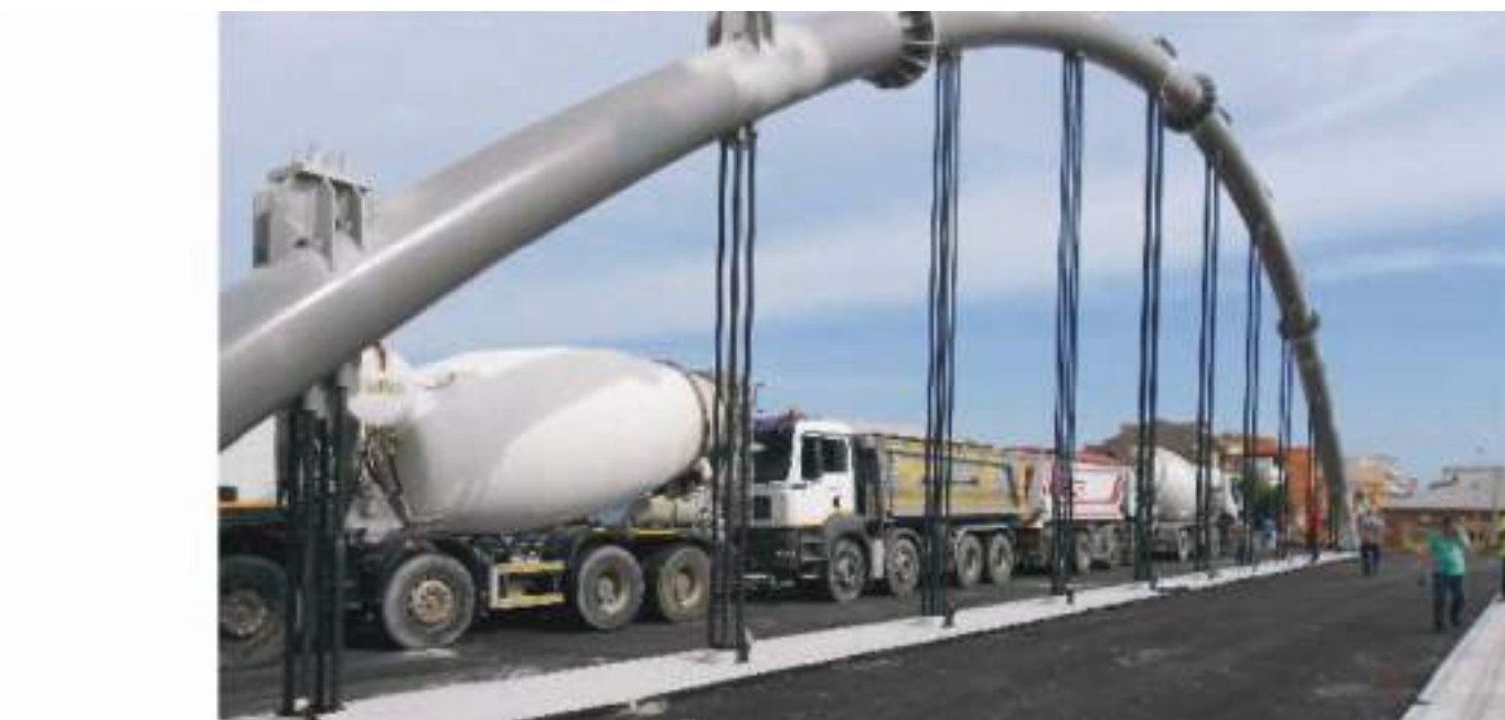
Fig. 27 | Configurazione di carico Q_a – Posizionamento dei carichi sulla struttura
