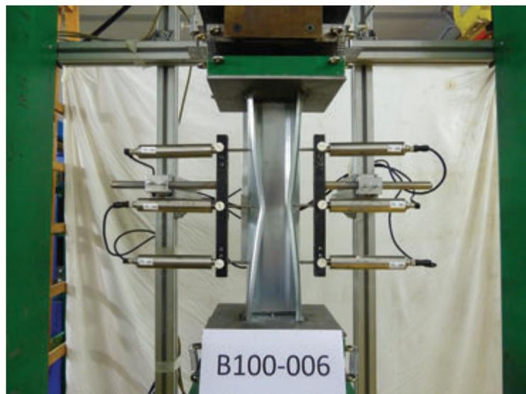
Fig. 4 | Prova di compressione su profilo SteelMAX.
