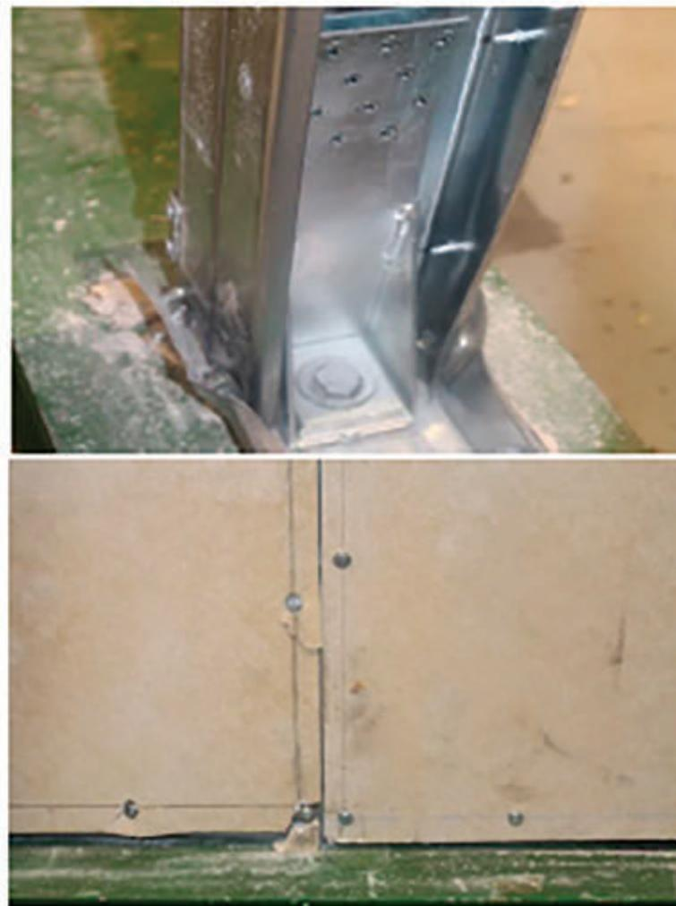
Fig. 6 | Prova sperimentale parete steelMAX con lastre di rivestimento.
