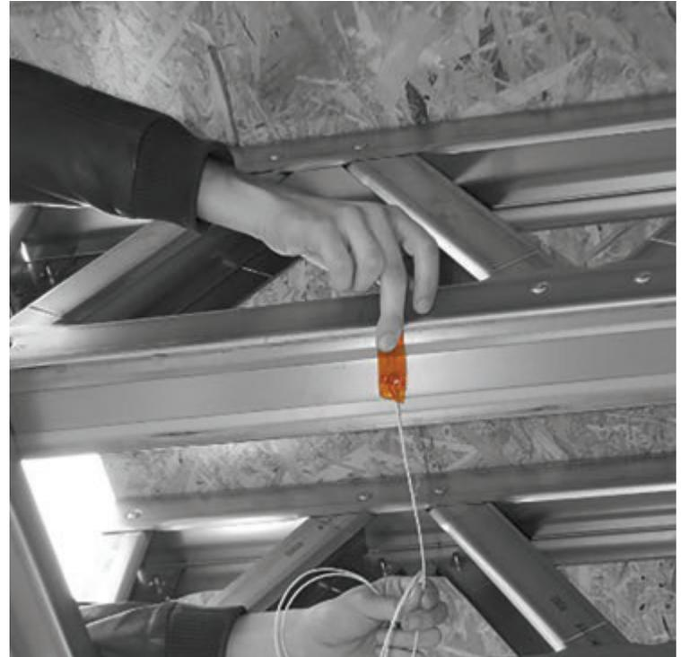
Fig. 27 | Posizione sensori per il monitoraggio ambientale.
