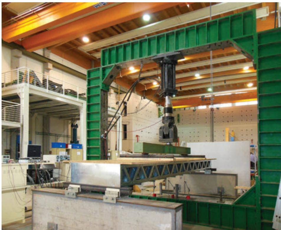
Fig. 9 | Prova di carico solaio steelMAX.
