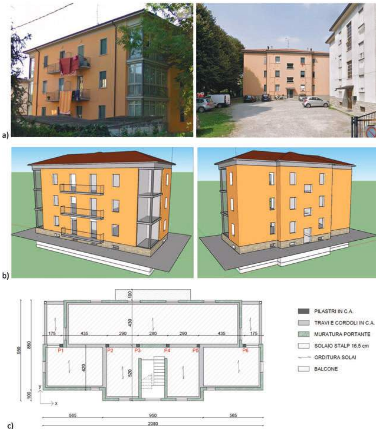
Fig. 2 | a) Fotografie dell'edificio; b) Viste 3D dell'edificio c) Pianta del piano tipo con indicata l'organizzazione strutturale
