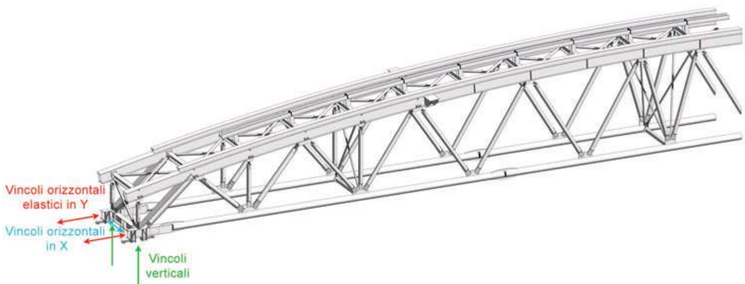
Fig. 9 | Modello Revit della trave reticolare binata principale e indicazione dei vincoli
