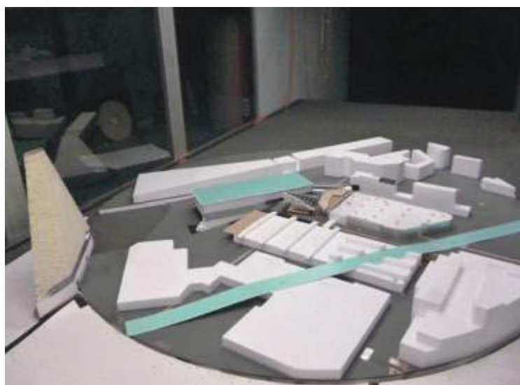
Fig. 4 | Modello in scala utilizzato per lo studio in galleria del vento.
