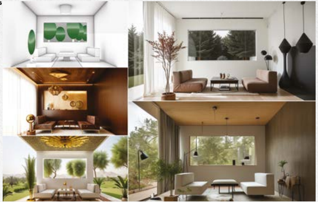
6 AI as rendering engine - indoor: (top left) the conceptual 3D model; (middle left, bottom left and on the right) various options generated with Stable Diffusion on textual description and the "misd" ControlNet pre-processor model / IA come motore di rendering - interno: (in alto a sinistra) il modello concettuale in 3D; (in alto al centro, in basso a sinistra e a destra) alternative generate con Stable Diffusion basate sulla descrizione testuale e sul modello di pre-process "misd" di ControlNet.
