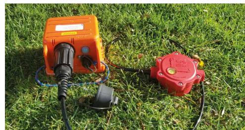
Ultra compatto, leggero, passivo, senza cavi sismici! Il sismografo a 3 canali per Vs a profondità di oltre 1 km.
