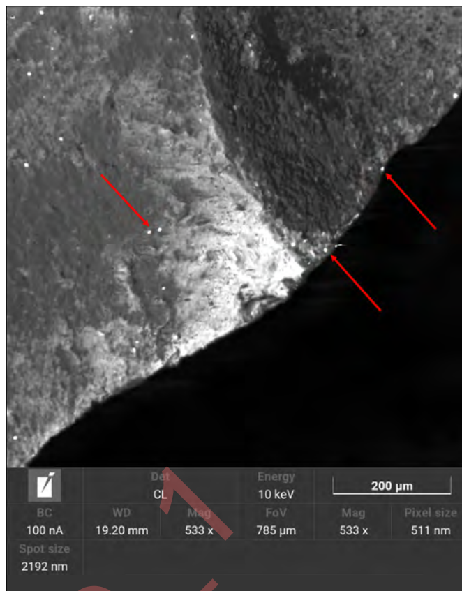
FIGURA 12. Immagine CL di una porzione di un frammento della frazione centimetrica del campione MB_1. Le frecce evidenziano gli spot che danno catodoluminescenza.
